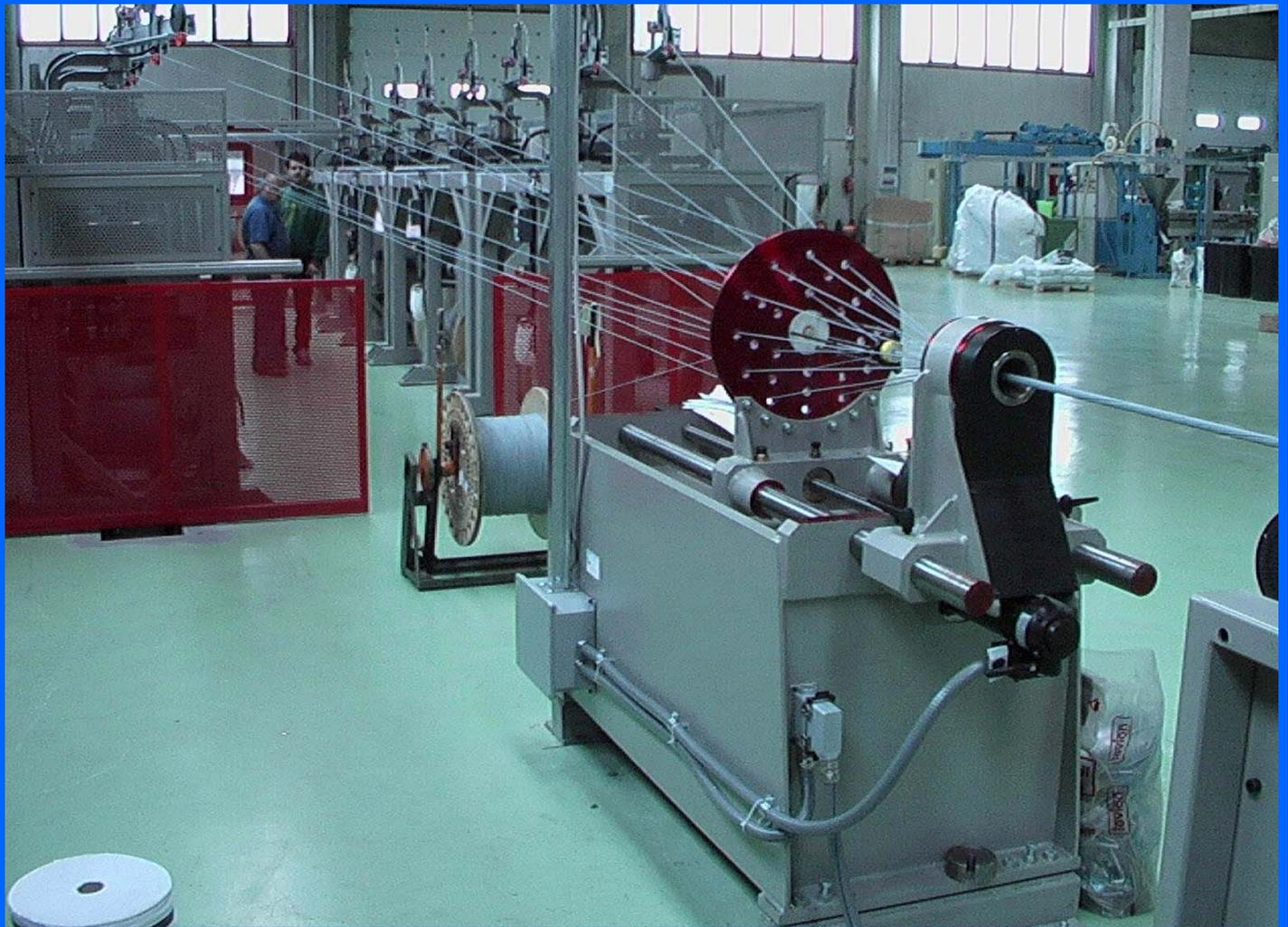
EINFACHSCHLAGVERSEILANLAGE ZUR VERSEILUNG VON SPEZIALKABELN, MIKROCOAX, MULTI L.A.N. SOWIE LWL-KABEL.
